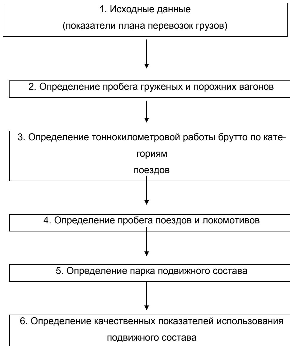
Рис 2.1. Схема расчета показателей плана работы подвижного состава
