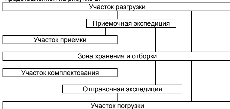
Рис2. Схема материального потока на складе торговой оптовой базы.
